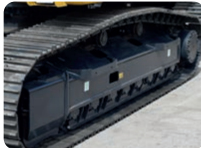
Onderrolbescherming over de volledige rupsplengte (optie)
