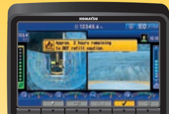
Nabehandelingssysteemregeneratiescherm voor het KDPF
