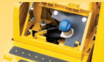
De AdBlue®-tank bevindt zich in de voorste trap en is makkelijk bereikbaar.
