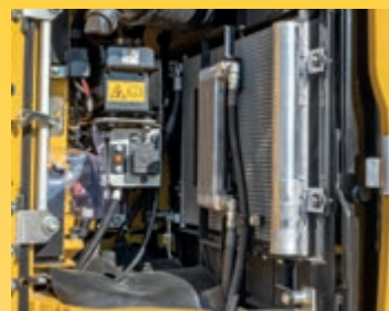
Laterale radiateuropstelling voor vlotte reiniging
