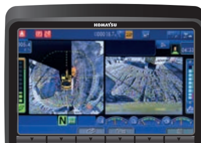
KomVision maakt het mogelijk om de machine steeds in "vogelperspectief" te zien dankzij de combinatie van verschillende camera's hoeken
