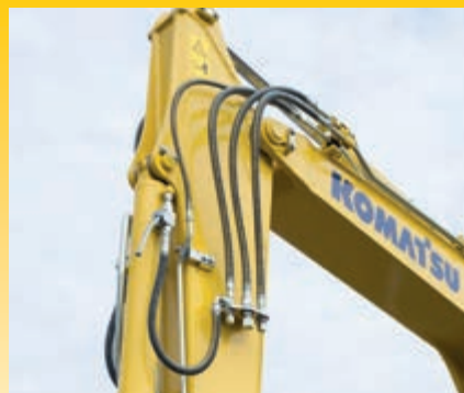
Standaard enkel- of dubbelwerkende hydraulische functie voor uitrustingsstukken en hydraulische snelwisselfunctie
