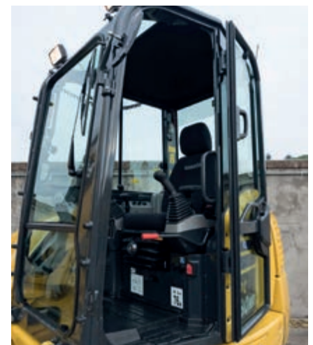
Nieuwe scharnierende deur voor vlottere toegankelijkheid
